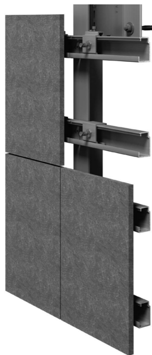
PROVEDENÍ SPÁR U PŘÍSTŘEŠKU. HLINIKOVÝ ROŠ BUDE PŘIPEVNĚN OBOUSTRANNĚ NA POZINKOVANÝ JAKL 100/100 TL. 6 - KOMAXIT ČERNÁ BARVA
